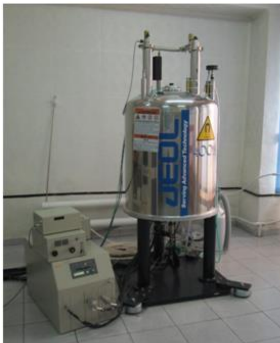
33-сурет – JNM-ECA 400. Ядролық магнитті резонанс спектрометрі.
